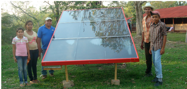
Solar-Luft-Kollektoren produzieren heiße Luft, die mit Ventilatoren und der Hilfe einer Photovoltaikanlage abgesaugt wird. Foto: CONA
